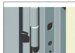
Cerniera con cuscinetto a sfera in acciaio. Rostro fisso antiscardino con rispettiva asola. Registro con regolazione telaio. Foro conico per vite di fissaggio.
