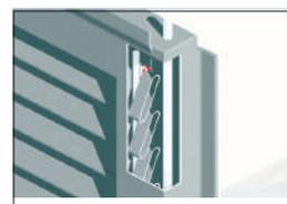
Tondino passante, utile per rinforzo e il bloccaggio delle lamelle.
